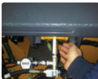
วาล์วป้องกันการร่วงหล่น (วาล์วนิรภัย) 낙하방지밸브(안전밸브)
