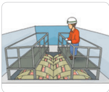
ติดตั้งราวนิรภัยรอบ ๆ นั่งร้าน 작업발판 및 안전난간 설치
