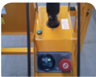
ปั๊มหยุดฉุกเฉินและอุปกรณ์ล็อกการควบคุม 비상정지장치 및 조작레버 잠금장치
