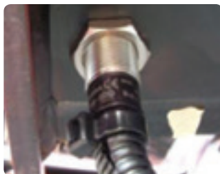
เซนเซอร์สำหรับแผ่นที่ยื่นออก มาด้านนอก 아웃트리거 감지 센서
