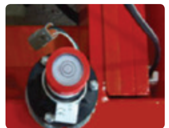
เครื่องบอกความเอียง (เซนเซอร์วัดระดับ) 경사표시장치(수평감지센서)
