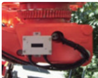
อุปกรณ์ป้องกันน้ำหนัเกินพิกัด (อุปกรณ์ที่ใช้วัดค่าแรงหรือโหลด เซลล์) 과부하방지장치(로드셀)
