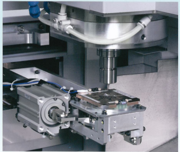
工具振れ再現性 2 \mu\text{m} 以下
