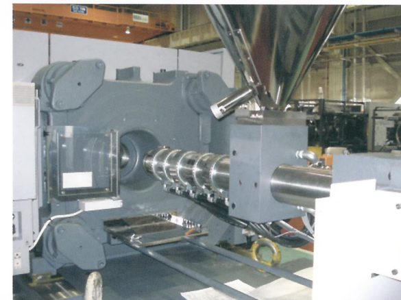
バルブ温度制御部 Barrel temperature control unit
