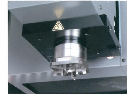
주축축 홀더를 Air Chuck으로 클램프 (사진은 EROWA-ITS Chuck 사양)
