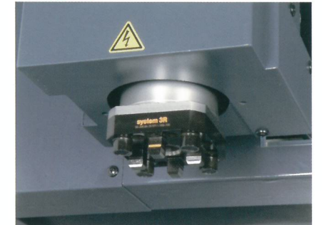
전극평탄도 및 분할가공 대응 주축중심에서 가공액 분출 (사진은 3R-MACRO Chuck사양)
